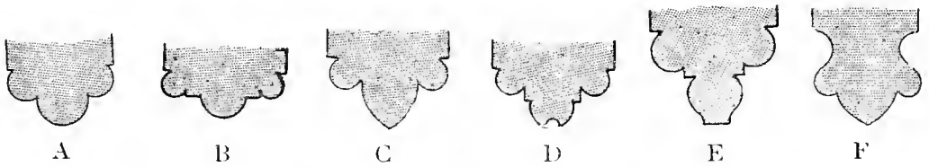
FIG. 220. — Profils à trois tores.
